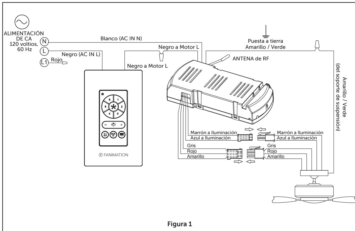
**NOTA:** El paso del "Proceso de emparejamiento" debe realizarse antes de que su ventilador funcione. Si reemplaza el receptor o las aspas, deberá volver a realizar el "Proceso de aprendizaje" antes de usar esta unidad.
